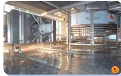
Double impingement crust freezing fan unit
